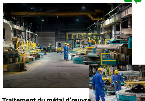
Traitement du métal d'œuvre en cuve d'affinage
